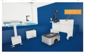
また、「ロボット運搬ソリューションエリア」では、「ロボこたつ&AGV ソリューション」で稼働する AGV がパレット搬送を行います。両エリアで同一の AGV を使用することで「AGV の使用台数の最適化」に繋がります。
